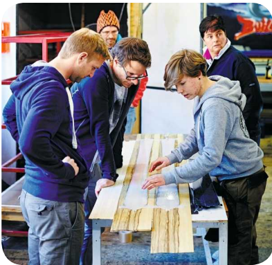
Bei der Arbeit: Furnier (links) und Stahlkanten (rechts) müssen richtig sitzen
