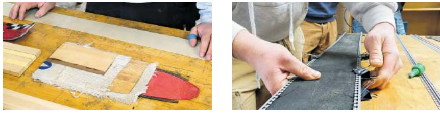
Alles, was dran ist: Belag mit Stahlkanten, Glasfasermatte, Holzkern, noch mal Glasfaser, Furnier (von unten nach oben). Erster Arbeitsschritt ist das Anpassen der Kanten.
