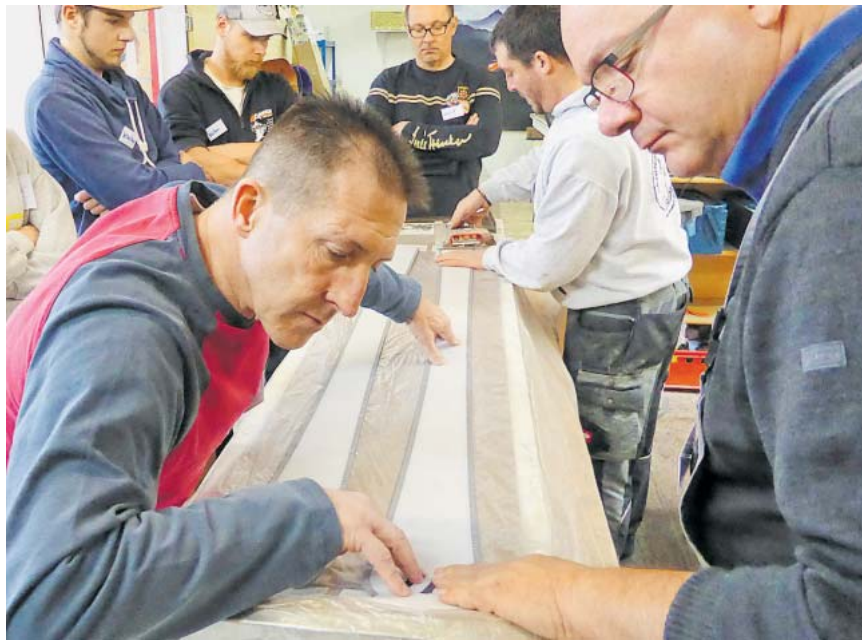
Handwerk: Laufflächen samt Stahlkanten werden auf der Laminierform festgetackert.
