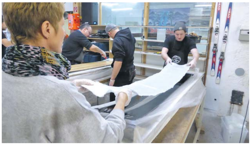
Tuchführung: Die erste Glasfaserlage, nach dem Holzkern folgt eine weitere.
