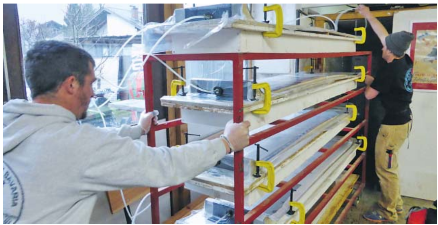
Backstube: In Vakuumsäcke verpackt kommen die Skier über Nacht in den Ofen.
