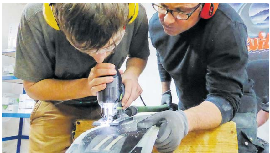
Sägearbeit: Mit leichtem Druck an der Stahlkante entlang - das Ausschneiden der Skier.
